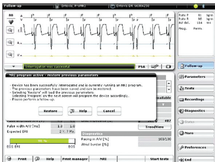
Figura 2: Tela do programador mostrando a programação após exame de ressonância magnética, em que os parâmetros anteriores ao exame são restaurados.
