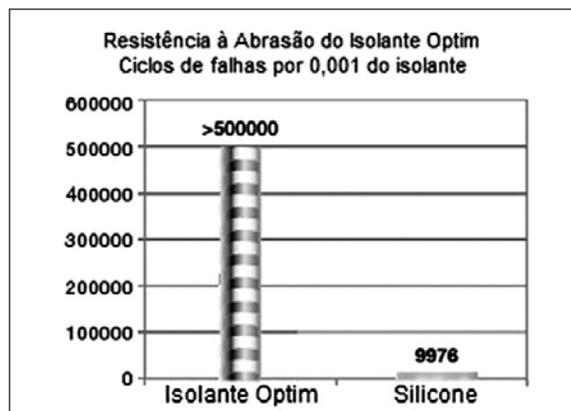
Figura 3 - Resistência à abrasão do Isolante *Optim*<sup>(\*)</sup>.
